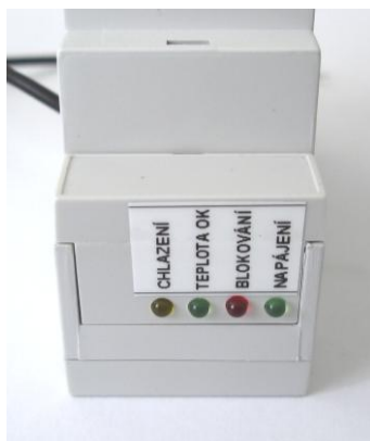
Obrázek č. 3 Pohled na kryt regulátoru s indikačními LED
