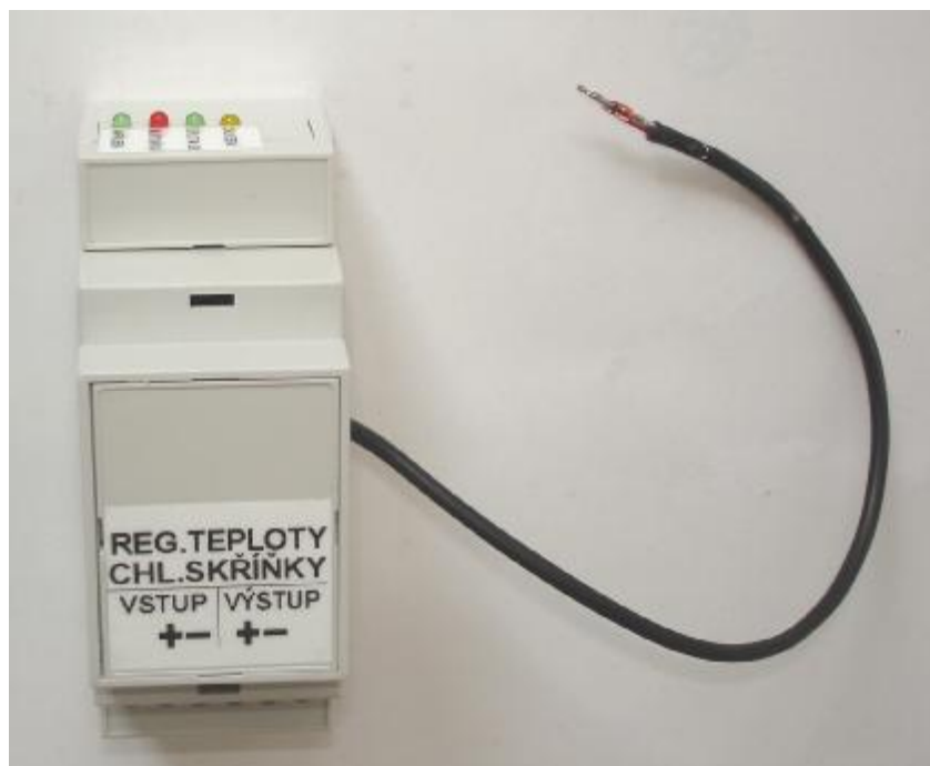
Obrázek č. 2 Regulátor chladicí skřínky
