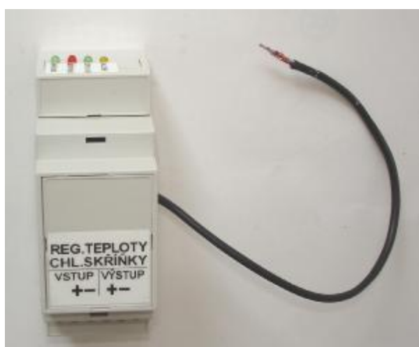
Obrázek č. 2: Regulátor chladicí skříňky
